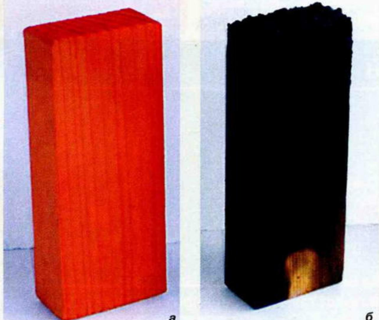
Фото 1. Зразки деревини сосни: а – оброблений «Префіксом»; б – оброблений «Префіксом» після випробування за ГОСТом 16363-98
